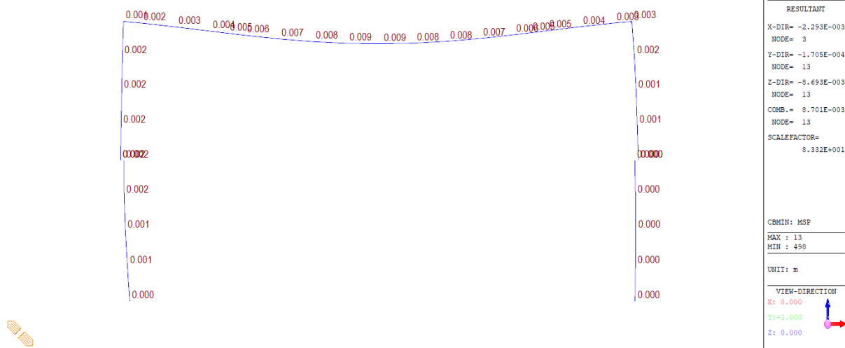
Obrázek 14: Deformace mezní stav použitelnosti
